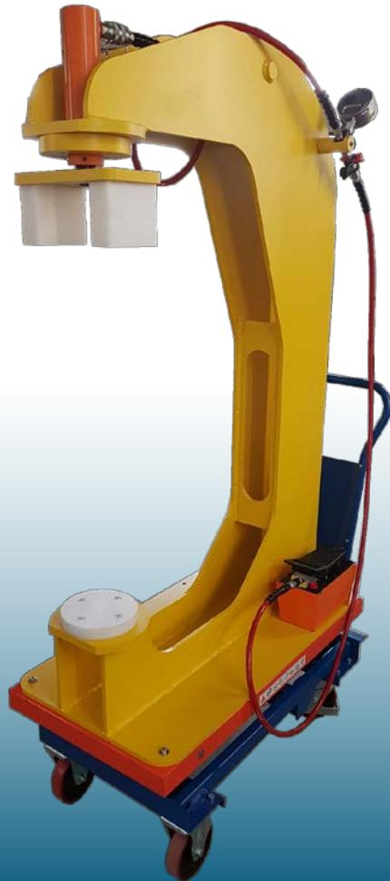
Equipée d'un vérin d'une capacité de 14 tonnes et d'une commande par pompe hydro-pneumatique, cet outil permet de compresser les ressorts de bogies pour permettre leur maintenance.
